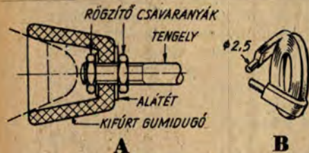
A felfogófej közvetlenül a ventilátor tengelyére csatlakozik
